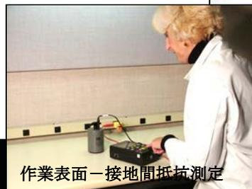
作業表面—接地間抵抗測定
