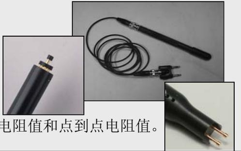
精确测量小范围表面电阻值和点到点电阻值。
