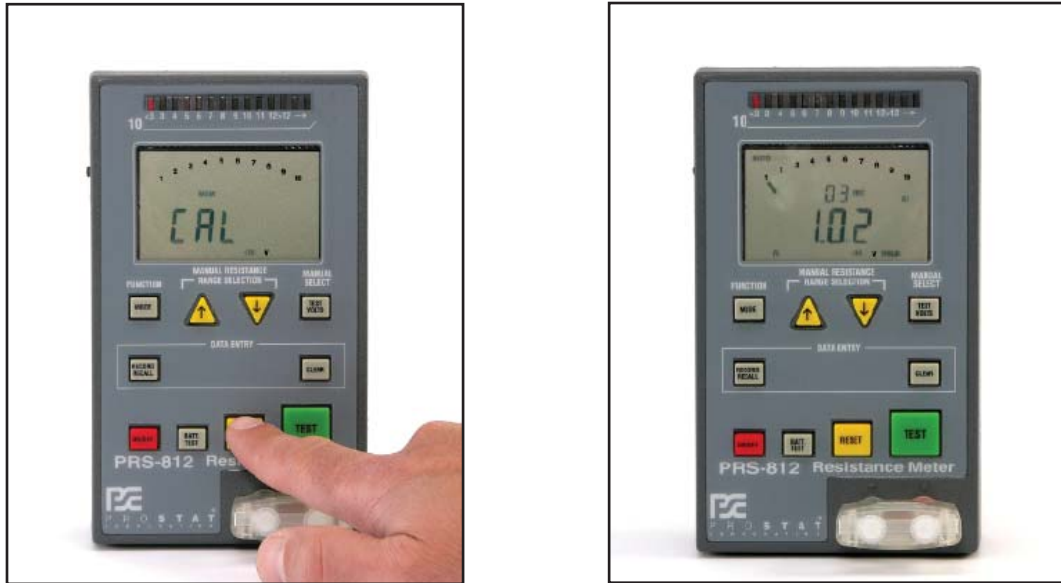
図 8: RESETを押して校正シーケンスを完了してください。TESTを押して校正シャントの抵抗を測定します。シャントの抵抗は 1.02 \Omega \pm 0.02 \Omega と表示されます。
