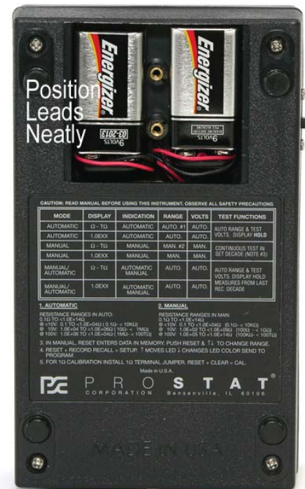
図 4: 2個の9V乾電池の取り付け
