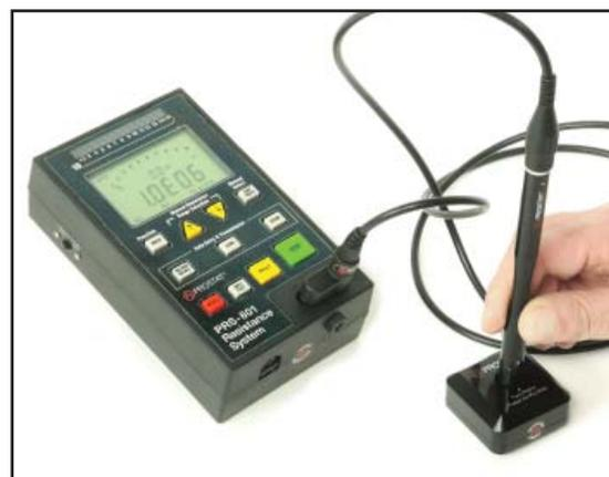
図 6: PRF-922B を PRV-913B 校正器に差し込みます。
