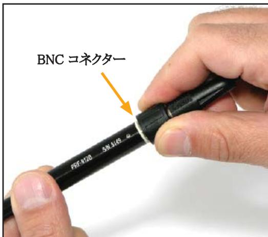
図 3: バナナプラグコンバーターにケーブルを接続します。
