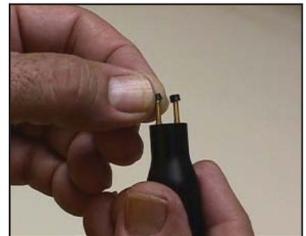
図 9: 導電性ゴム電極ブーツのインストール
