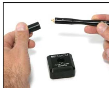
図 5: プローブカバーを外します
