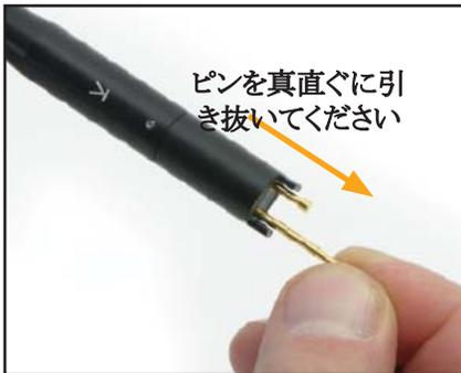
図 8: テストプローブをしっかりとつまんでソケットから真直ぐに引き抜いて外してください。
