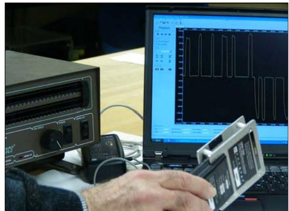
図51: ベンチトップイオナイザの減衰時間測定
