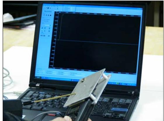
図50: チャージプレート(CPM)を $1,000\text{V}$ 以上に帯電させます。
