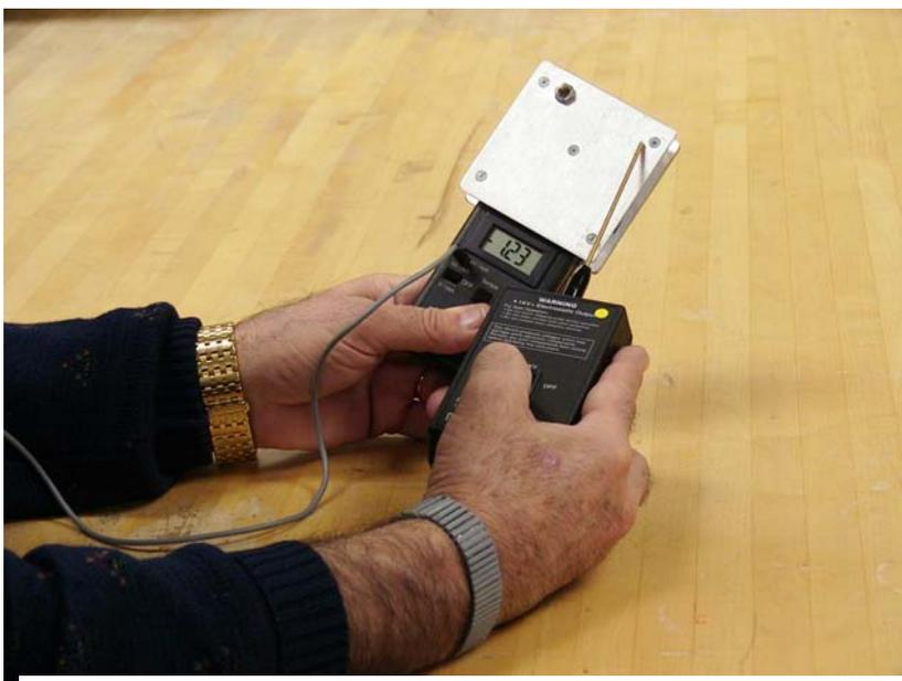
図 37: PCS-730 は必ず確実に接地を取ってください
