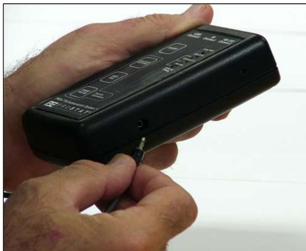
図3: フィールドメータの出力端子とAutoanalyzerの入力端子の接続
