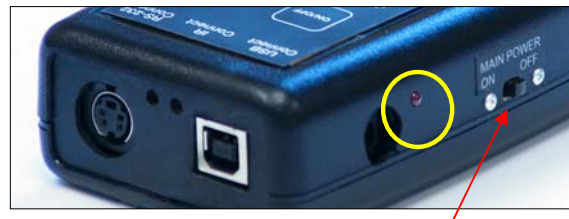
図 7: Main Power Battery Bus Slide Switch は保管中にバッテリーとの接続を切離します。
