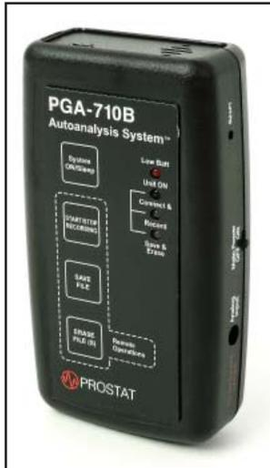
PROSTAT® PGA-710B は、PFK-100フィールドキットを使用する帯電データ分析用のデバイスです。
