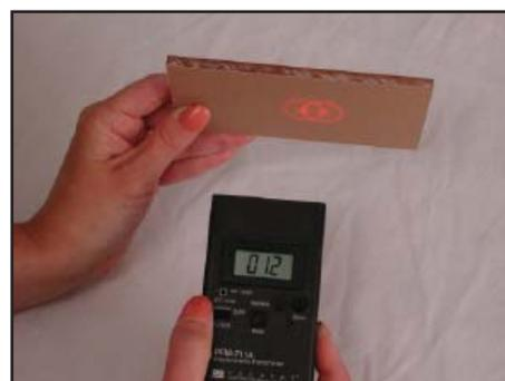
3. PFM-711A電界計の頂部にあるセンサは、測定対象物の表面から1インチ(約2.5cm)の距離が測定位置です。LEDからの赤色の2つのリングが重なり合う距離が、1インチに設定しています。電界計を測定物に近づけたり離したりして2つのリングが重なる位置を確認してください。
