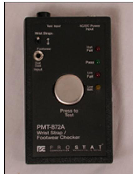
Cuando se utiliza correctamente, el PMT-872A automáticamente efectúa una secuencia automática de prueba para confirmar la correcta operación y prueba del voltaje de baja batería. El PMT-872A puede utilizarse ya sea como una unidad portátil o instalándose permanentemente en una ubicación conveniente para las funciones de prueba diarias.
