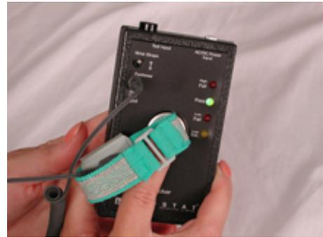
e. Si sólo mitad de un sistema aceptable está siendo correctamente probada, verá que se ilumina el LED mientras intenta automáticamente medir el "rango". La secuencia de luces LED será:
