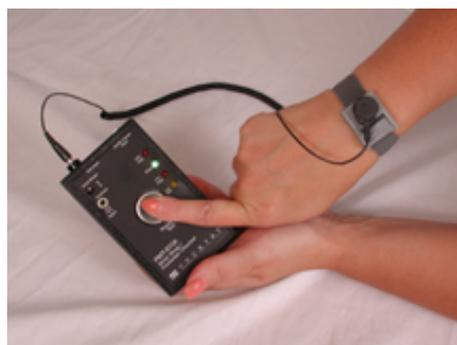
(4) Comienza a sonar la alarma acústica (bip) cuando termina la prueba y la Muñequera está dentro del rango de resistencia admisible estando puesta.
