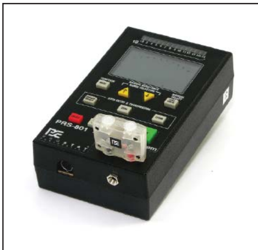
圖 6: 使用標準1Ω旁路校準器進行低阻值範圍校準
