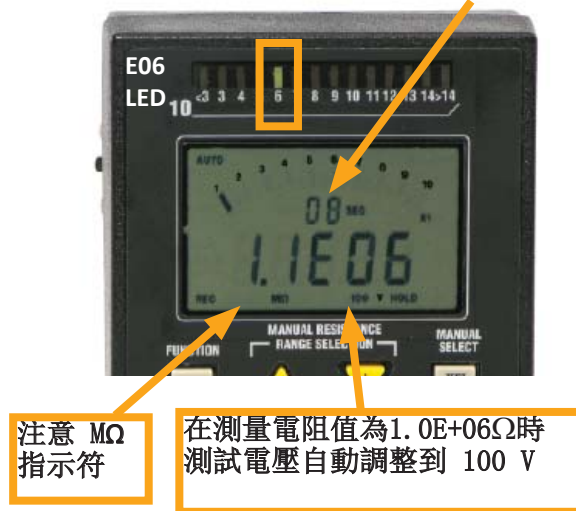
图 13: 在測量 1.0\text{E}+06\Omega 到 <1.0\text{E}+14\Omega 範圍電阻值時，
