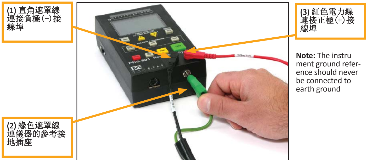
圖 9：遮罩導線組的連接
