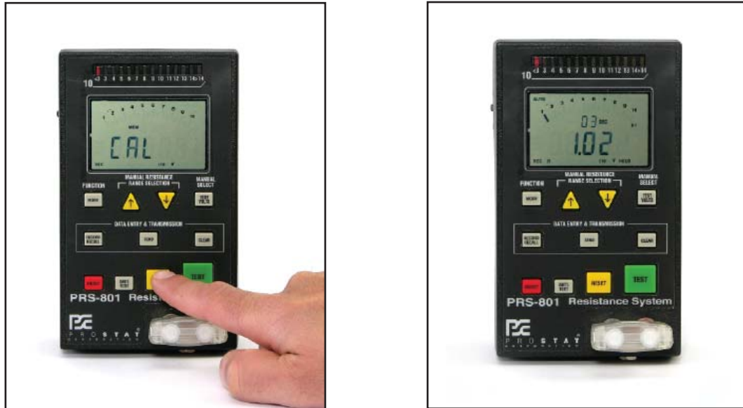
圖 8：按RESET鍵以結束低電阻範圍校準過程。按TEST鍵測量旁路校準參考電阻值，以進行校準。測得的旁路校準參考電阻值應該在 1.02\Omega \pm 0.02 \Omega 範圍內。
