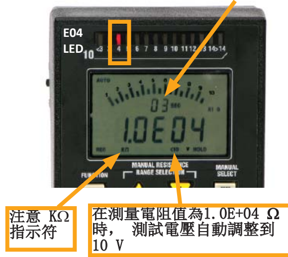
圖 12: 在測量 1.0\text{E}+04\Omega 到 <1.0\text{E}+06\Omega 範圍電阻 值時，測試電壓將自動調整到10V
