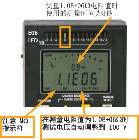
图 13: 在测量1.0E+06Ω到 <1.0E+14Ω范围 电阻值时，
