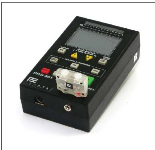
图 6: 使用标准1Ω旁路校准器进行低阻值范围校准
