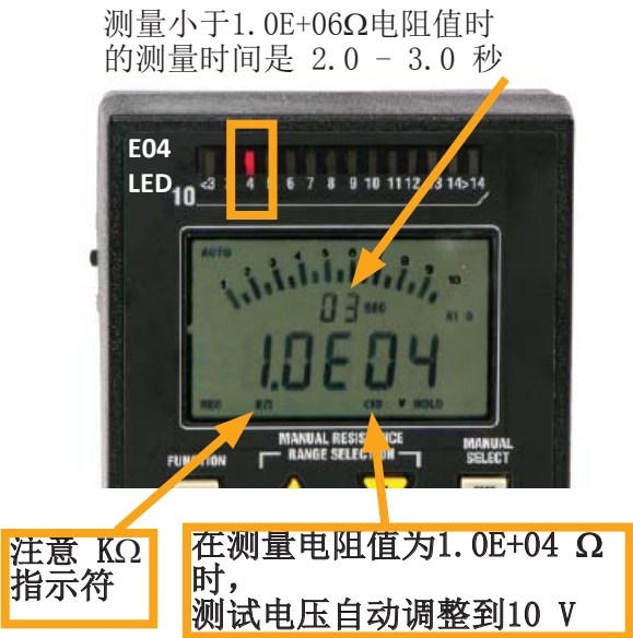
图 12: 在测量1.0E+04Ω到 <1.0E+06Ω范围电阻值时， 测试电压将自动调整到10V
