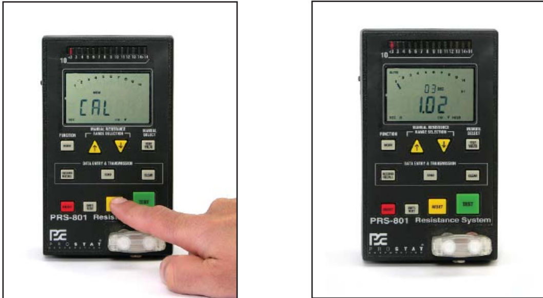
图 8：按RESET键以结束低电阻范围校准过程。按TEST键测量旁路校准参考电阻值，以进行校准。测得的旁路校准参考电阻值应该在 1.02\Omega \pm 0.02 \Omega 范围内。
