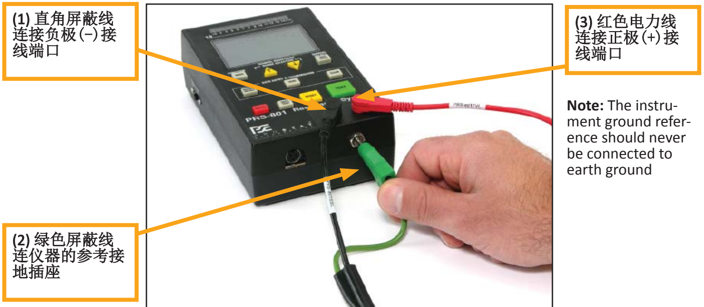
图 9：屏蔽导线组的连接
