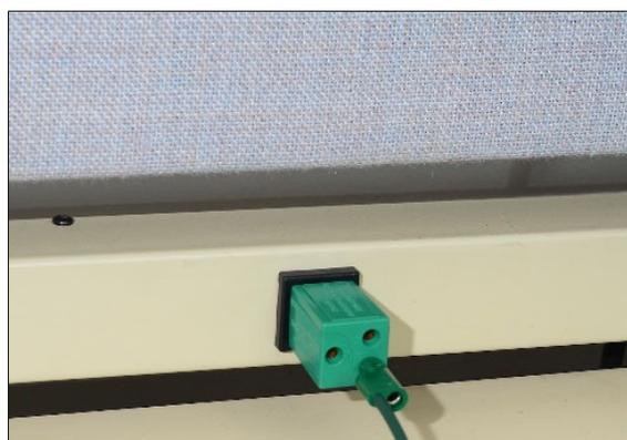
图 4. 将 PRF-911GGL 测试线的另一端连接到 Q007B 接地立方体
