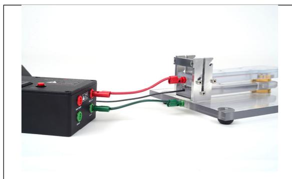
图 2. 将 510-054 导线的另一端连接到放电臂, 将短的绿色测试线连接到底座
