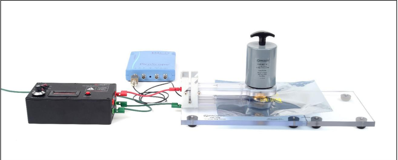
图 13. 屏蔽袋测试安装完成。
