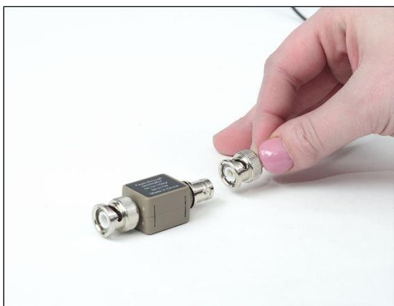
图 5. 将 50 欧姆的端接器连接到 Tektronix® CT1 电流探头
