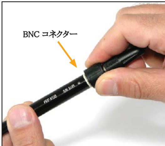
図 5: バナナプラグコンバーターにケーブルを接続します。
