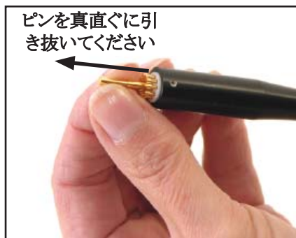
図 10: テストプローブをしっかりとつまんでソケットから真直ぐに引き抜いて外して下さい。
