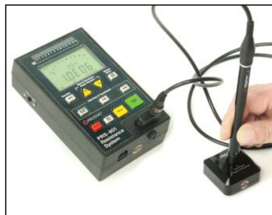
図 8: PRF-912BをPRV-913B校正器に差し込んで基準抵抗を測定します
