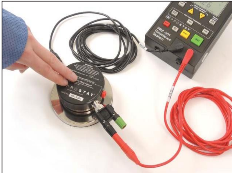
図 8: テストベッドと電極との接触状態の確認
