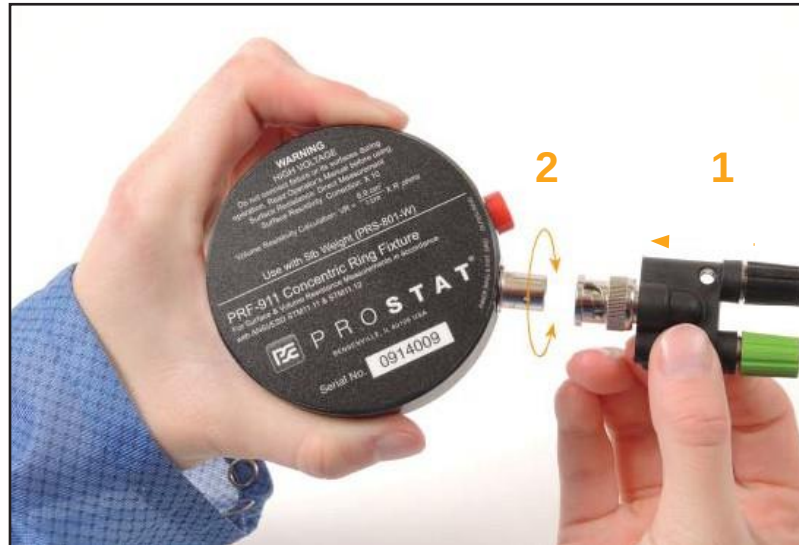
図 4: BNC アダプタの取付け方法
