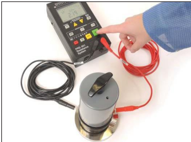
図 9: 電極とテストベッドとの接触の確認
