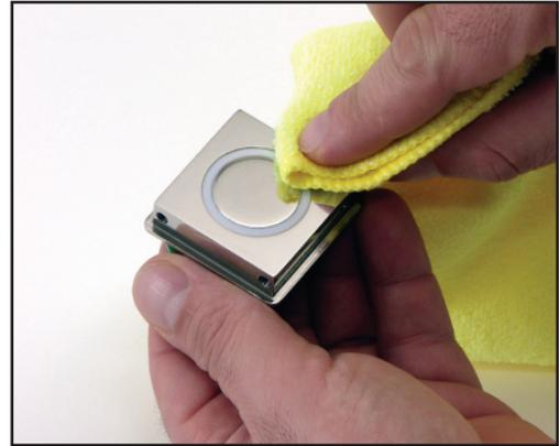
**Figure 12: Reinigung der Stromplatte mit Isopropyl-Alkohol und Mikrofaser-Tuch**
